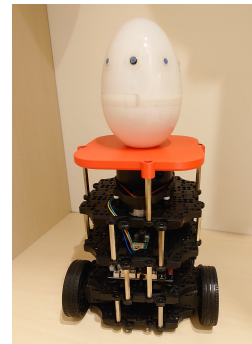
図 8: ROBOTIS 社 TurtleBot3 Burger に 8ch マイクロフォンアレイ TAMAGO (SYSTEM IN FRONTIER Inc.) を搭載したロボット.
