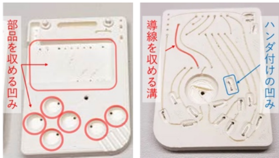
図 1 Konow 氏が公開している基板の部品面(左)と半田面(右) ([1]より引用し, 注釈を追加)
