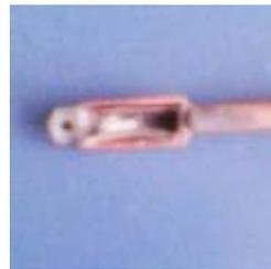
白金ボートを載せた試料導入棒の先端。
