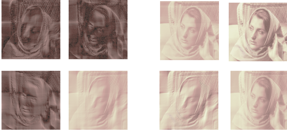
図 9: 左: 4 つの前フィルタリング P_{(\pm, \pm)} によって得られた画像 (左) と 4 つの前フィルタリングによって得られた画像を 2 つ加えて得られる近似画像 (右) .
