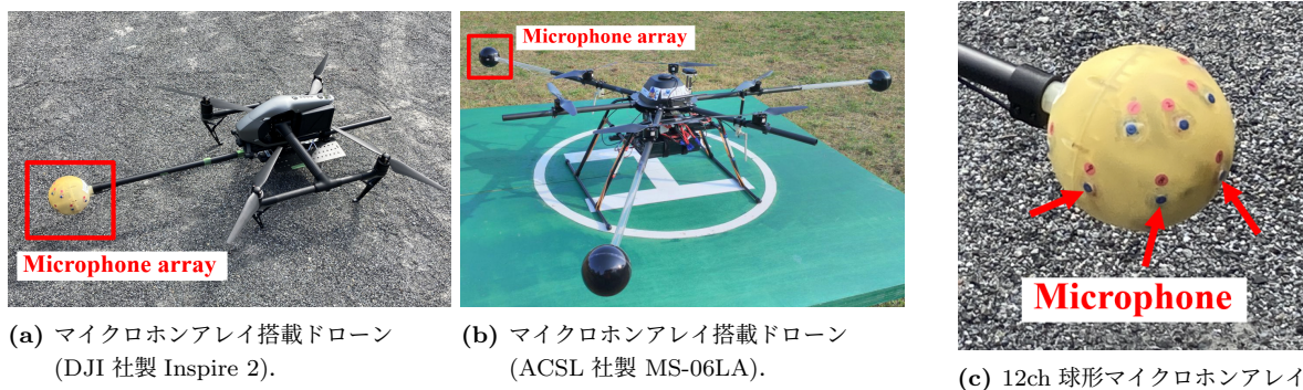
図 11: 実験にて使用したドローンおよびマイクロホンアレイ。
