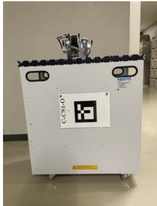
図 2: RCLL で用いる MPS とそれに貼り付けた ArUco マーカー
