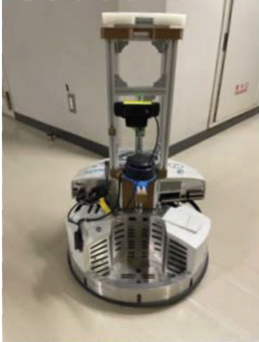
図 1: RCLL の競技で用いるフェスト社製の全方位移動式ロボット Robotino
