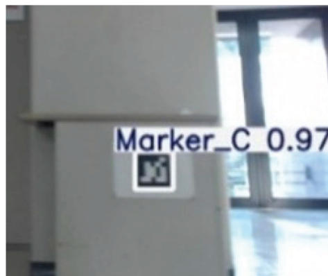
図 3: YOLOv5 でのマーカー検出結果
