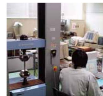
接着継手の引張試験
