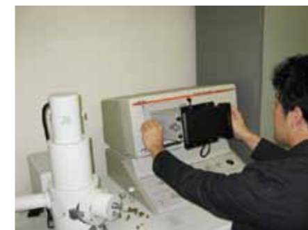
走査型電子顕微鏡による加工面の観察
