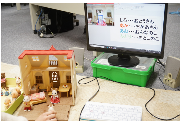
図 6: 床にカーペットを敷き、ドールハウスシステムを設置した。ディスプレイの右に人形検出時に表示する四角の色が対応する人形を示している。
