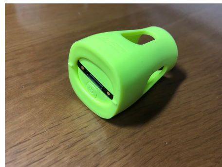
図 1: スマートテニスセンサ：ラケットのグリップエンドに取り付けることができ、ストロークの球種、速度、回転数などを測定することができる。
