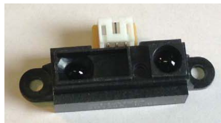
Figure 5: 距離センサ GR2D120 の外観。左側が受光部、右側が送信部である。
