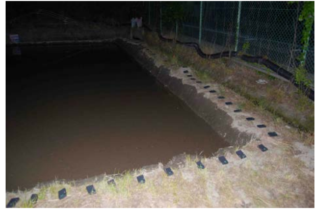
Figure 4: 音声可視化装置「カエルホタル」を用いた野外調査 (京都大学構内の水田にて撮影)。カエルホタル数十台をあぜ道に沿って並べ、その様子をビデオカメラで撮影した。
