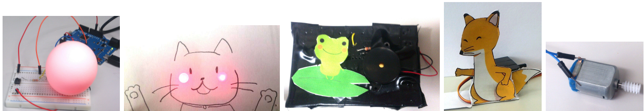
図 2: 制作例は左から、キャンドルライト（卵の殻を LED にかぶせる）、イラストの一部を光らせる（猫の絵を描いた紙を LED を 2 つ載せたブレッドボードにかぶせる）、イラストから音を出す（カエルを描いた紙を圧電スピーカを載せたブレッドボードにかぶせる）、模型を動かす（狐の絵をかき、ラジコンサーボのサーボホーンにつけた尻尾を動かす）、モータを動かす（モータ単体を回転させる）である。
