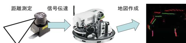
Figure 1: 距離センサと制御部分
