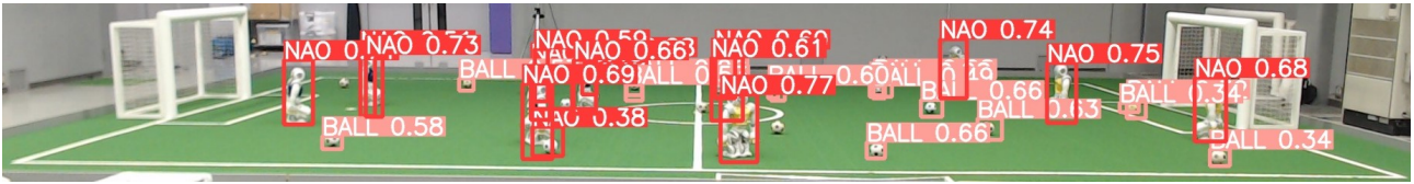
図 4: YOLOv5 による認識結果 (図 2 の画像をテストに使用した結果)
