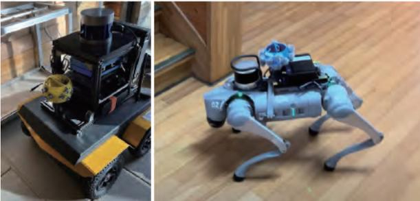
図 3: Clearpath JACKAL(左) と Unitree Go2(右). 16ch の円筒形マイクアレイと LiDAR を搭載.
