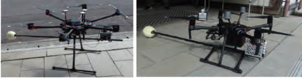
図 2: DJI Matrice 600 Pro(左) と DJI Matrice 210 RTK V(右). 各ポール先端に、軽量特殊ウレタン製風防を付けた 16ch 球形マイク・アレイ (白色) を設置
