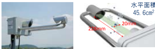
柏原キャンパスC1棟屋上に設置されている雨滴粒径分布計
